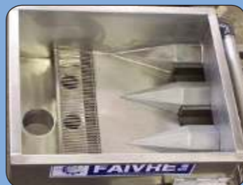
Vista del interior de la tolva de entrada con, en opción un picado para una bomba de separación de agua
