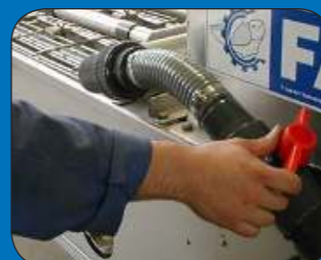
Alimentación de agua totalmente regulable mediante válvula
