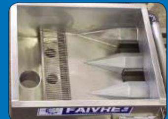
Vue de l'intérieur de la trémie d'entrée avec en option un piquage pour une pompe à poissons et un séparateur d'eau.
