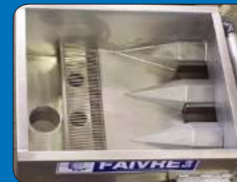
Вид изнутри бункера подачи рыбы с опцией подключения насоса для рыбы и сепаратором воды.
