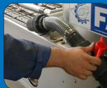
Подача воды полностью регулируется клапаном
