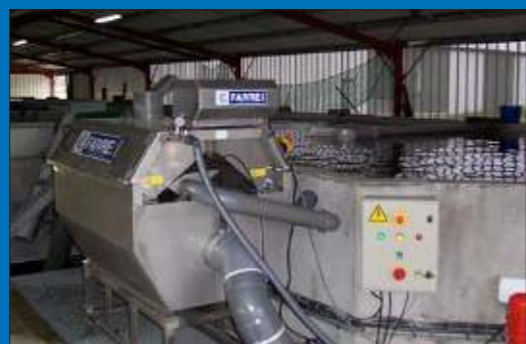
Modell 4-80 mit 60µ Sieb in geschlossenem Kreis einer Störzucht
