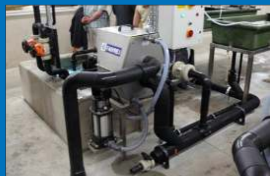
Modell 2-40 mit 36 Mikron Sieb in geschlossenem Kleinkreis.
