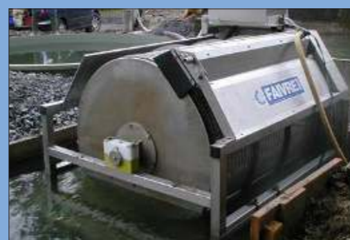
Modelo 9-120 en armazón (salida de piscicultura)
