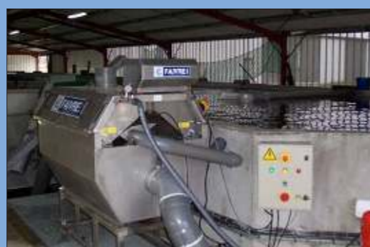
Modelo 4-80 con tela 60µ en un circuito cerrado.
